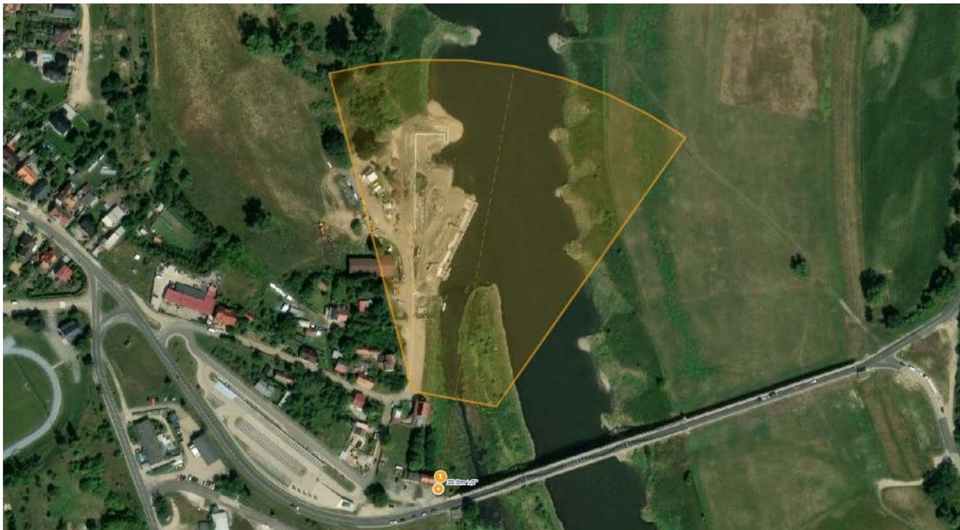
Rysunek 129: Ścinawa, wieża radiowa - kierunek obserwacji oraz wymagany obszar widoczności dla kamery stałej
